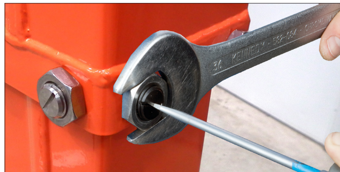
Seřízení šroubu opotřebení stožáru
