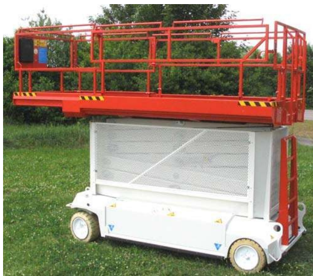
Vysunutá pracovní plošina
